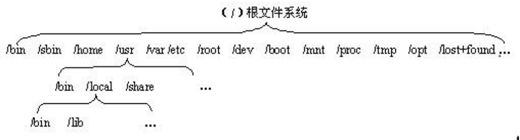
图 4.1 Linux 树型目录结构
